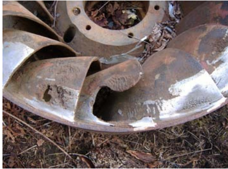
Σχήμα 5.19 Διάβρωση σπηλαιώσης σε στρόβιλο[23]
