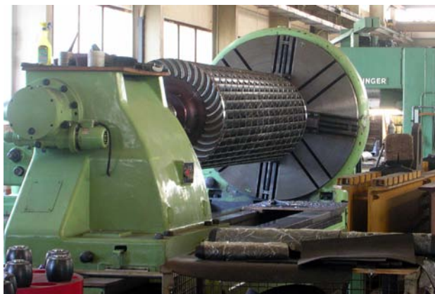
Σχήμα 5.9 Δρομέας στροβίλου Cross-flow[23].
