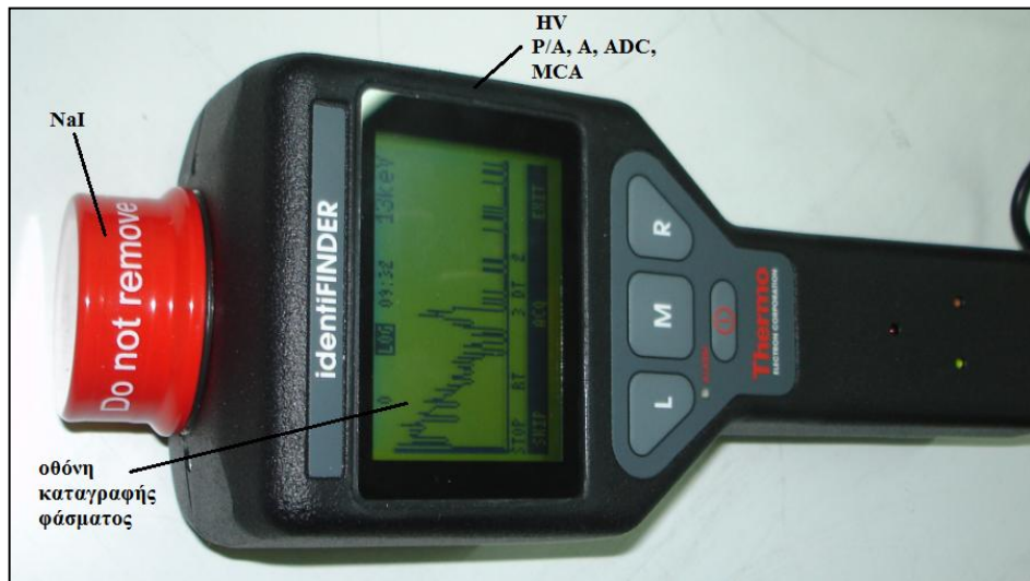
Σχήμα 8. Φορητό σύστημα φασματοσκοπίας ακτίνων-γ.
