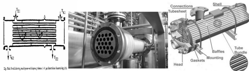
Σχ. 5.6. Εναλλάκτης σωλήνων-κέλυφος τύπου 1-1 με βασικό διάτομο (1)
