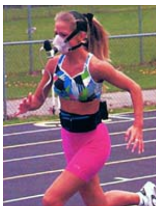
Εικόνα 1.4. Αυτόματο εργοσπιδρόμετρο για τη μέτρηση της πρόσληψης οξυγόνου εύκολα μεταφερόμενο κατά τη διάρκεια φυσικής δραστηριότητας. Το μεταβολικό σύστημα ζυγίζει περίπου 0.5 kg, με διαστάσεις 10 X 20 cm (McArdle et al., 2000).
