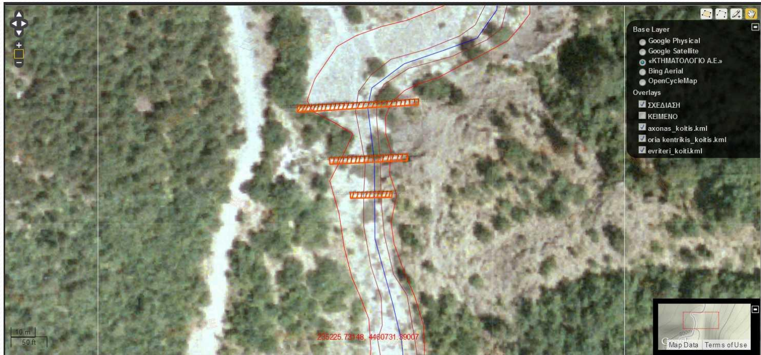
Σχήμα 68: Αποτύπωση φραγμάτων – προφράγματος
