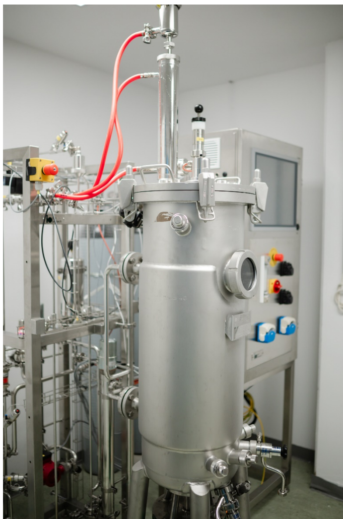
Εικόνα 2. Πιλοτικής κλίμακας βιοαντιδραστήρας συνεχούς λειτουργίας, συνολικού όγκου 70 L.
