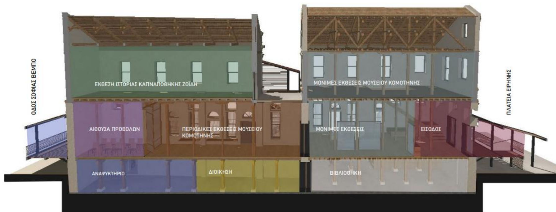
Ελ. 2 Διάγραμμα κτηριολογικού προγράμματος και ένταξη του στους υφιστάμενους χώρους του μνημείου.
