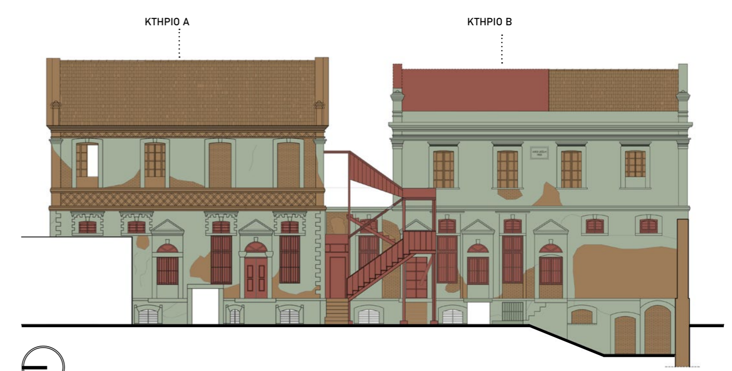
ΔΥΤΙΚΗ ΟΨΗ ΚΤΗΡΙΩΝ Α & Β
