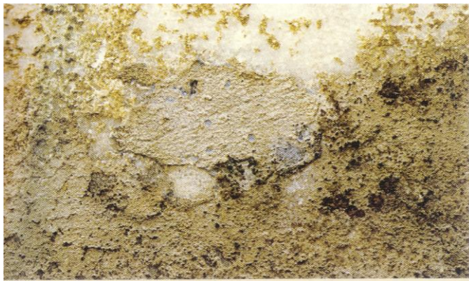
Εικόνα 1. Αρχαίο χρώμα (αιγυπτιακό μπλε) από τον Παρθενώνα, καλυμμένο με επίστρωμα (αποτέλεσμα μεταγενέστερης επέμβασης). 4
