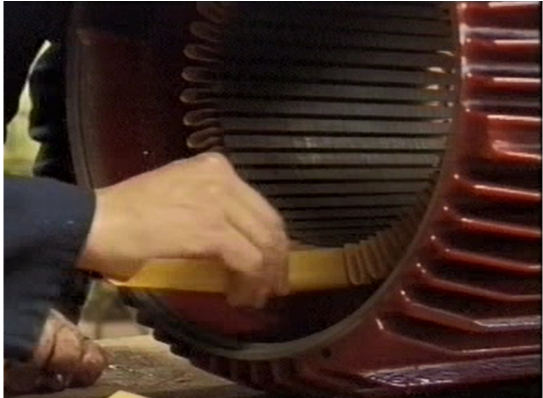
Τοποθέτηση μονώσεων στα αυλάκια του πυρήνα
