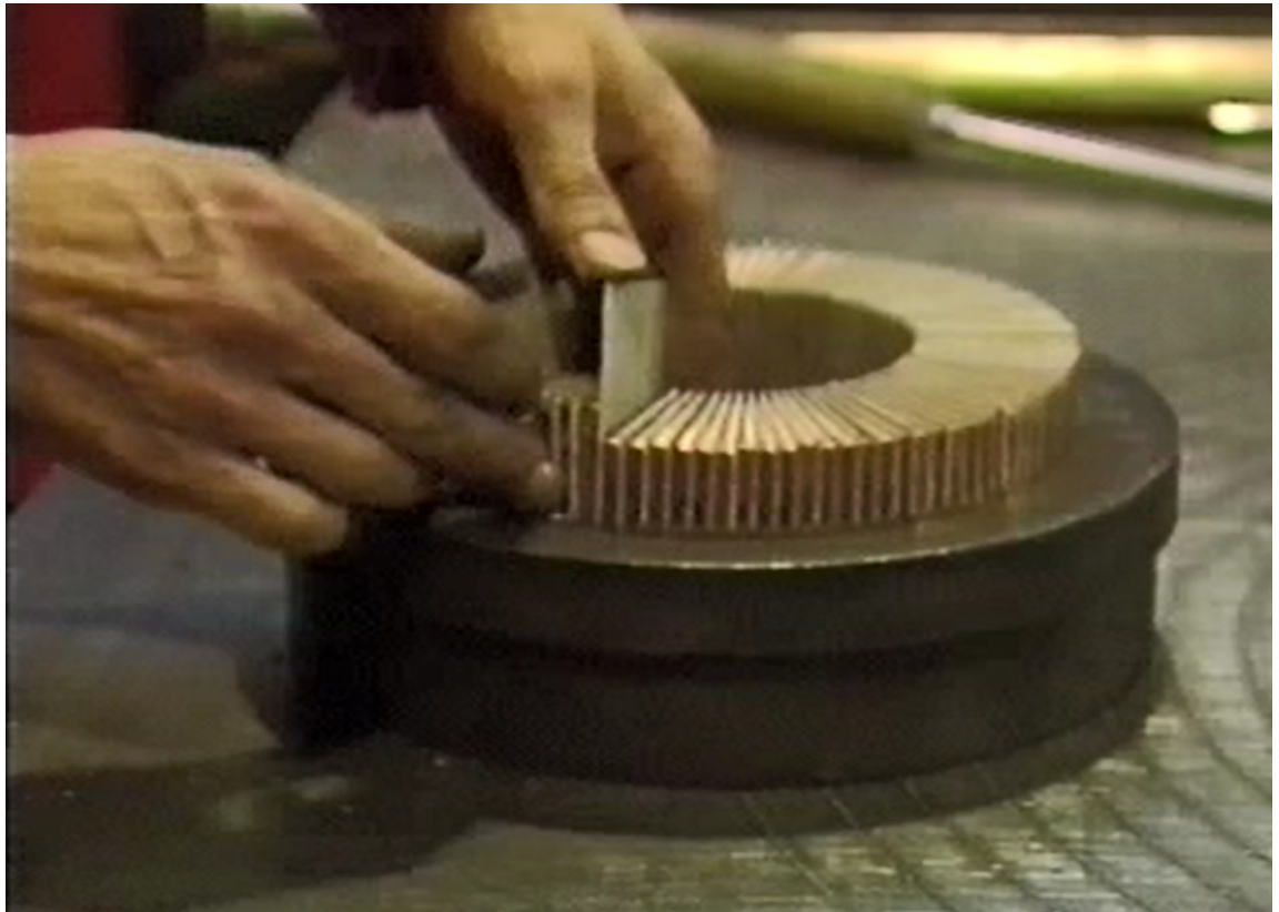
Ανακατασκευή συλλέκτη μηχανής Συνεχούς Ρεύματος
